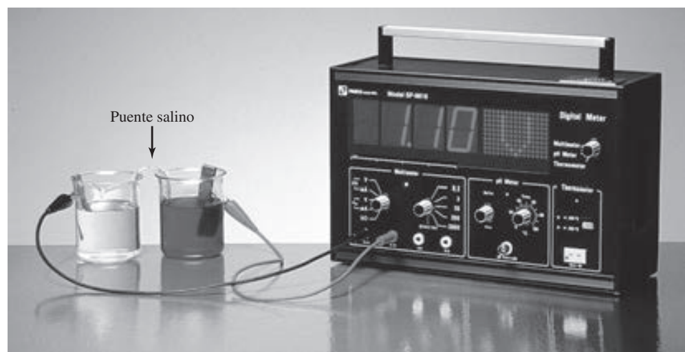
Figura 12.2 Disposición práctica de la celda galvánica descrita en la figura 12.1. Observe que el tubo en forma de U (puente salino) conecta los dos vasos de precipitados. Cuando las concentraciones de \text{ZnSO}_4 y \text{CuSO}_4 son 1 molar (1 M) a 25°C, el voltaje de la celda es de 1.10 V. Ninguna corriente fluye entre los electrodos durante una medición de voltaje.
