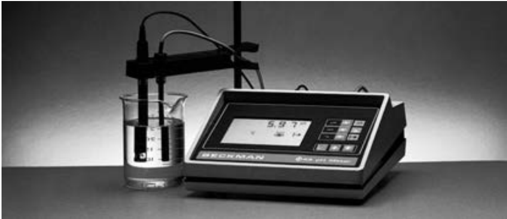
Figura 11.2 Un medidor del pH se utiliza comúnmente en el laboratorio para determinar el pH de una disolución. A pesar de que muchos medidores del pH tienen escalas marcadas con valores que van de 1 a 14, los valores del pH, de hecho, pueden ser menores a 1 y mayores que 14.
