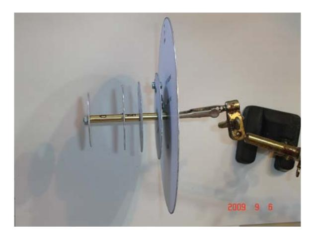
Queda por soldar el cable , en mi caso he empleado cable LMR200 , he de decir que la longitud es crítica , la longitud máxima del cable debe ser de 237cm , yo lo he dejado en 150cm que se corresponde con 12 Landas, si necesitáis más longitud , deberéis ir incrementándolo de en pasos de 12.5cm. hasta un máximo de 19 Landas.
