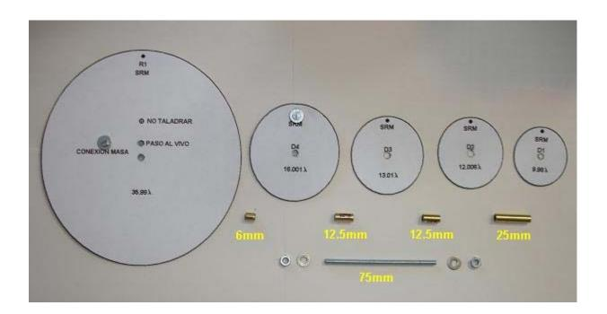
Tan sólo queda montarla , el tornillo pasante es de 75 mm , mayor que la del conjunto montado que es de 58.5 mm , es para sujetar el " SRM " al brazo.
