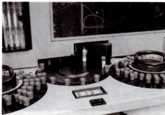
FIGURA 5-6. Paramax. El carrusel de carga distribuye tubos a uno de transferencia, del cual ocurre el muestreo, y después las muestras son transferidas a un carrusel de descarga. (Fotografía cortesía de Dade International.)
